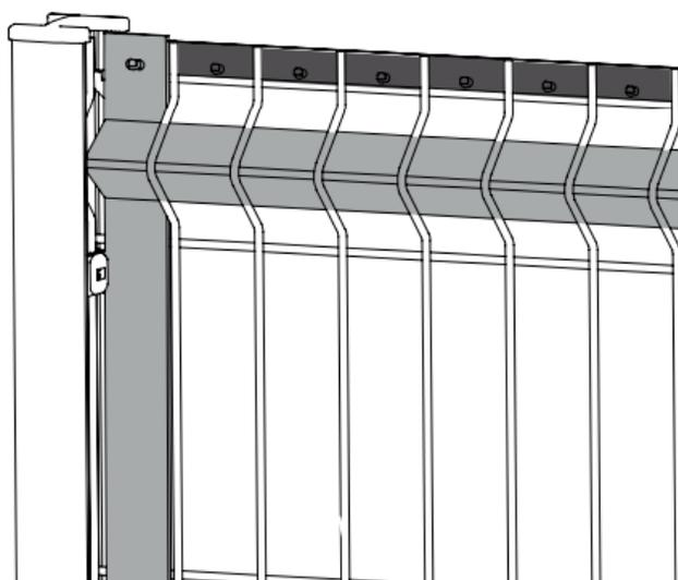
Insérer un premier triangle de renfort et glisser une latte d'extrémité (côté poteau) pour le maintenir. Glissez les autres triangles du dessous. Enfin fixez la latte à l'aide d'une réglette
