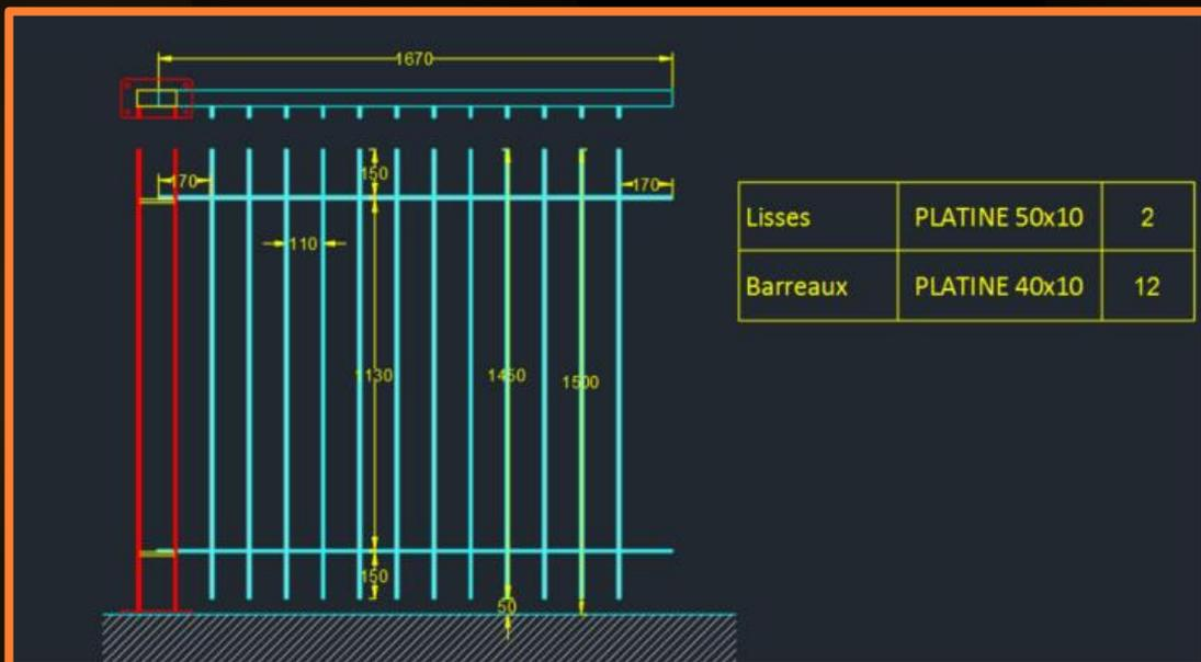
Fixation des panneaux par embouts
